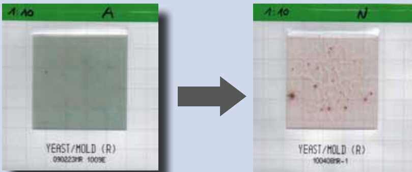
Abbildung: Naturbelassene Gerstenkörner (vermahlen, 1:10 verdünnt mit 0,9 % NaCl-Lösung) aufgetragen (je 1 ml) auf die RIDA®COUNT Yeast & Mold Rapid Testkarte im bisherigen Format (links) und auf die Testkarte mit neuem, verbessertem Nachweissystem (rechts)
